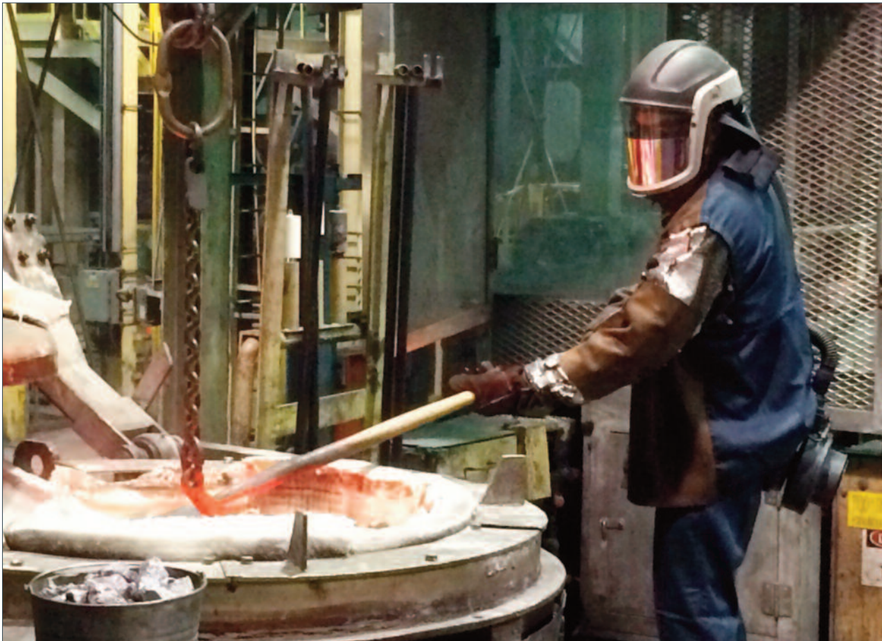
Un opérateur qui s'affaire à préparer la fonte pour les opérations de scellement.
