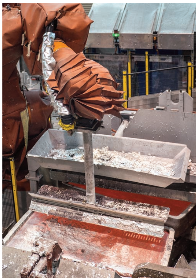
Un des robots écumeurs, installé au carrousel 401 du centre de coulée.
